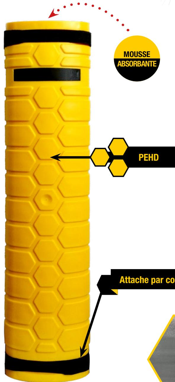
La protection rigide PlastroChoc® installée sur vos montants d'échelle va repousser la majeure partie des chocs donnés par vos appareils de manutention à l'aide de sa coque arrondie alvéolée et amortir l'autre partie des chocs avec un coussinet absorbant placé entre la coque et le montant.
